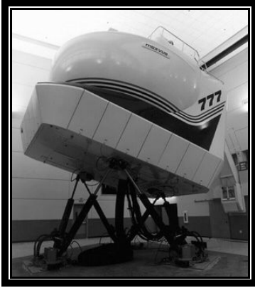
شكل (٤) الغرفة بشكل كامل من الخارج للبيئة الافتراضية لنظام محاكاة الطيران
